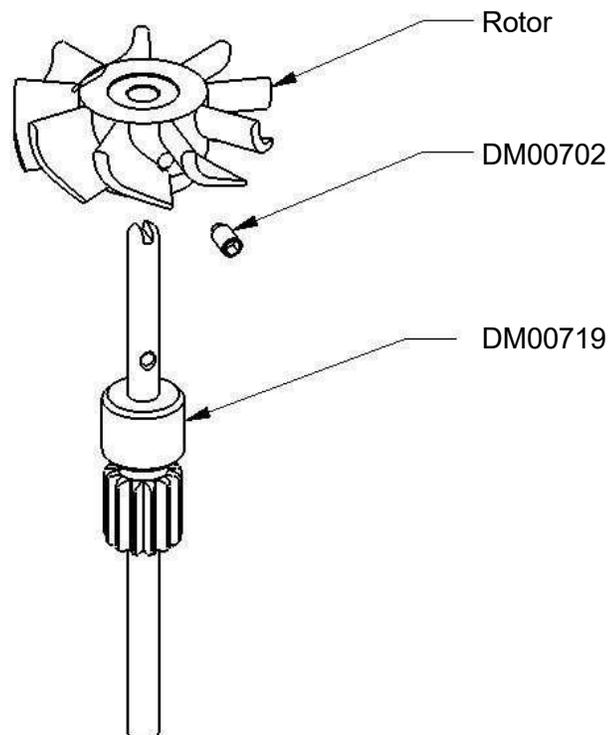
Figure 7: Rotor (turbine) subassembly
